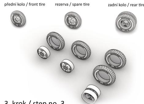
Nejprve si samostatně nabarvěte pneumatiky a disky kol. Dbejte na to, abyste sestavili sadu levých a pravých kol. Orientujte se podle vzorků na pneumatikách. Kola rezervy se liší svým diskem, který nemá imitace matic. Mají znázorněné otvory.
