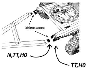
Pro snadnější odstranění podpěr jsou na některých místech technologické přídatky, které je nutné po odsranění podpěr odštipnout, či zapilovat.
