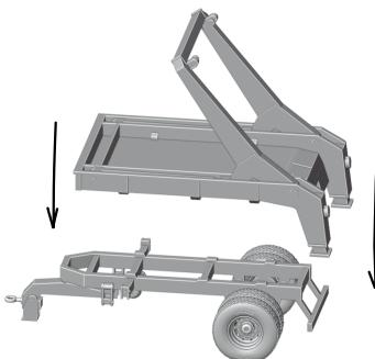
Nyní můžete ramenový nosič přilepit k podvozku. Dbejte na to aby ste dodrželi symetrii. Pro správné ustavení vám pomůže obrázek bokorysu v kroku 11.
